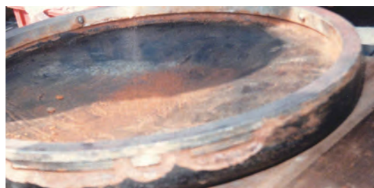
海水によって腐蝕されたスイング逆止弁の弁体
