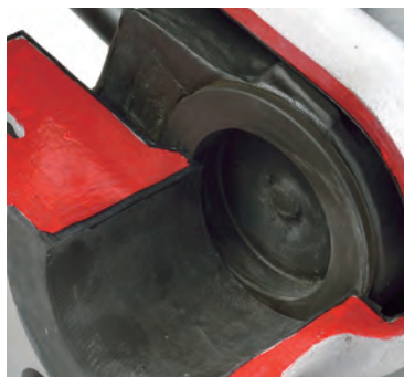
仕切弁の内部
